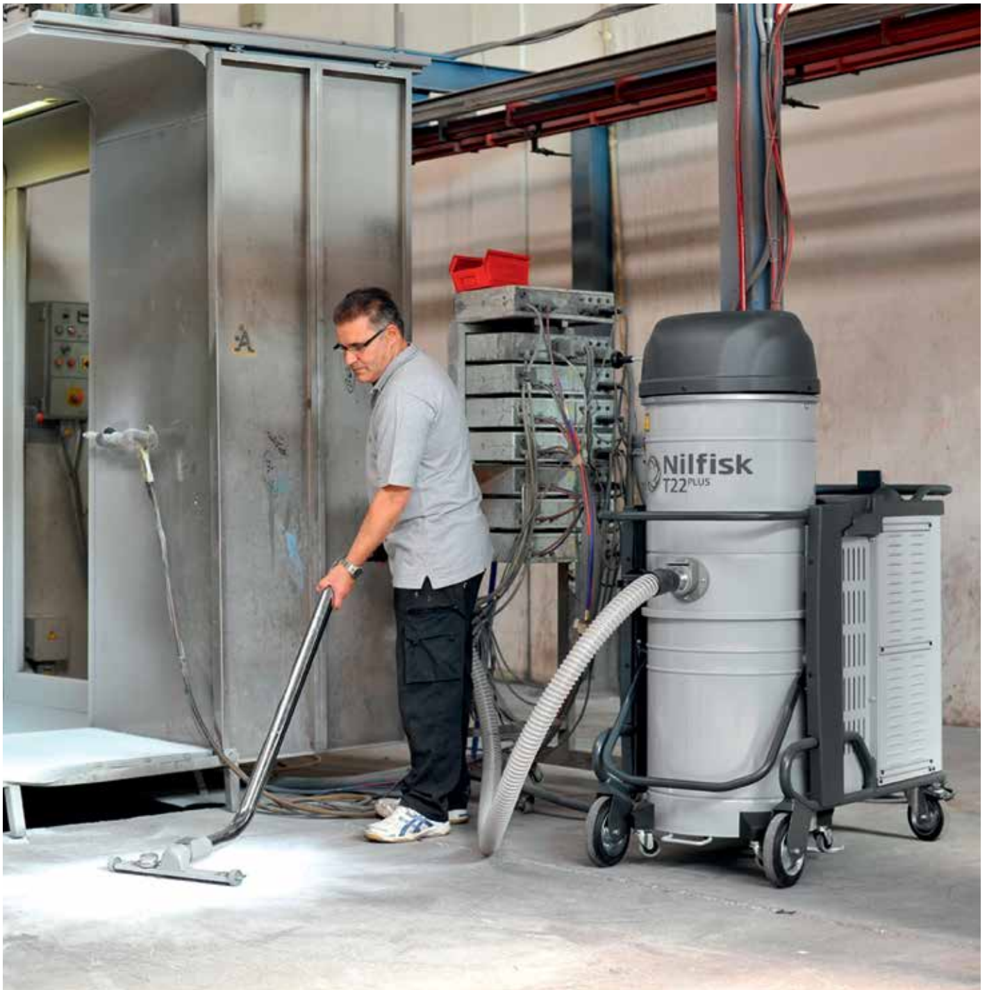
Aspirazione di polvere di vernice epossidica in totale sicurezza
