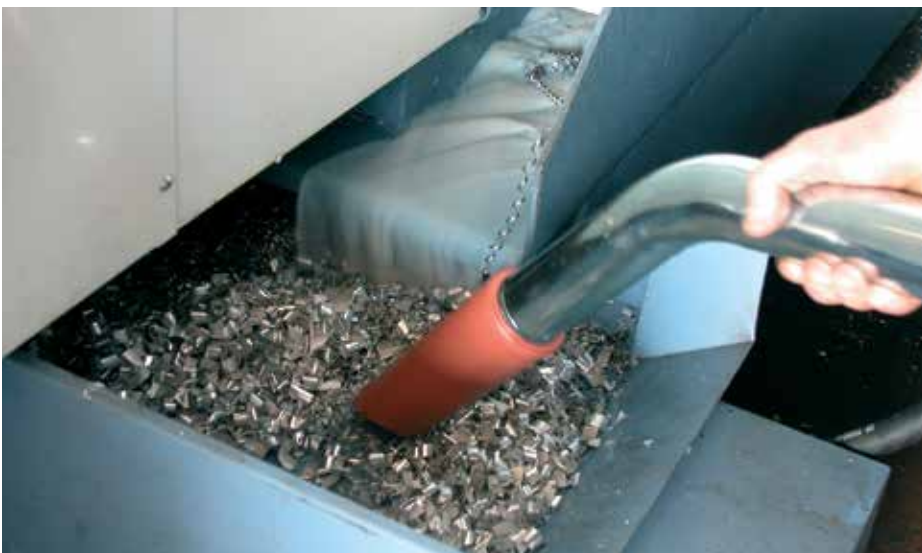
Aspirazione di grandi quantità di scarti di lavorazione
